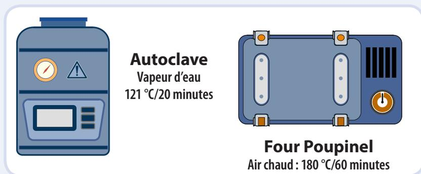
Dans les appareils autoclaves, la stérilisation se fait avec de la vapeur sous pressions.
